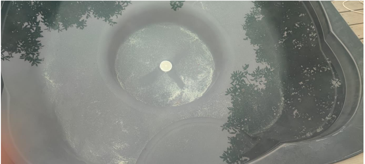
Mynd 1. Brennisteinsútfellingar á botni heits potts í Norðurnesi í Kjós, eftir að fullur pottur af ylvolgu affallsvatni (12-14°C) var hitaður upp í 40°C með því að láta fullheitt (78°C) jarðhitavatn renna í hann og blandast við affallsvatnið.
